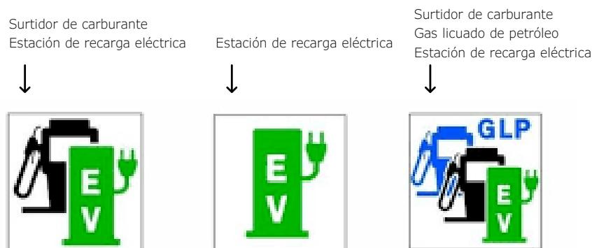
Figura 19. Pictogramas oficiales de señalización de estaciones de recarga eléctrica
