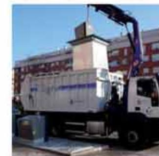
Los camiones van provistos de una grúa telescópica que engancha al buzón -la parte visible- del contenedor soterrado.
